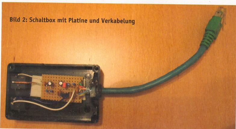
Bild 2: Schaltbox mit Platine und Verkabelung
