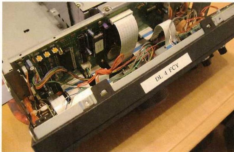
Bild 3: TS-790E geöffnet mit herausgeklappter Frontplatte
