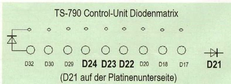
Bild 4: Skizze zur Diodenanordnung
